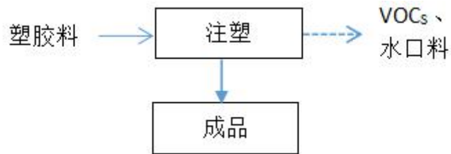
图6.2 配套塑胶零件生产工艺流程及产污图
